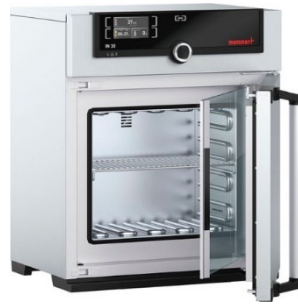
Figure 12: Incubateur pour l'industrie agroalimentaire (Memmert, 2021)
