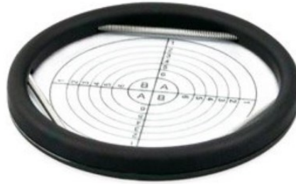
Figure 102 : Grille de comptage Spiral (Interscience, 2022)
