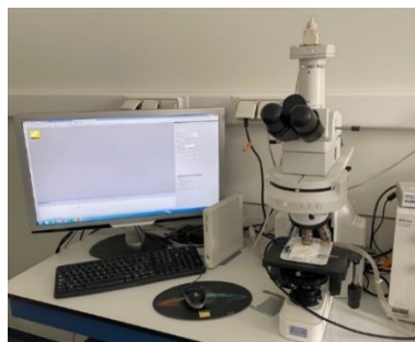
Figure 85: Microscope optique Nikon DS-Fi2 (Gembloux Agro-Bio Tech, 2022)
