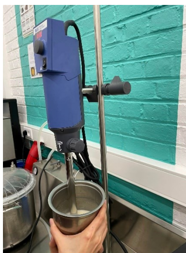
Figure 75 : Homogénéisateur T 18 digital Ultra Turrax de la marque Ika
