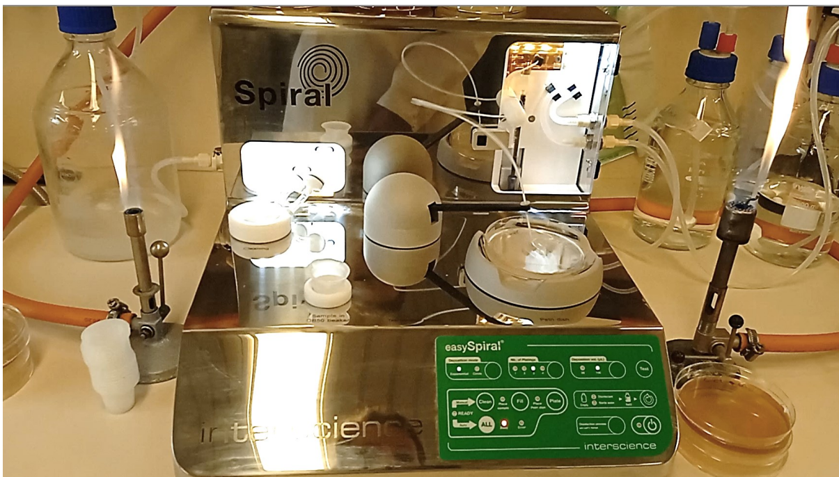
Figure 101 : Disposition des becs bunsen autour de l'ensemenceur automatique (Easy Spiral de Interscience)
