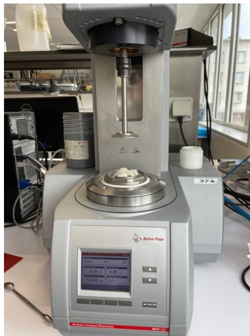
Figure 81 : Rhéomètre Anton Paar® Modèle MCR 302 (Gembloux Agro-Bio Tech, 2022)
