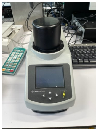
Figure 82: Colorimètre spectrophotomètre HunterLab type ColorFlex EZ© (Gembloux Agro-Bio Tech, 2022)
