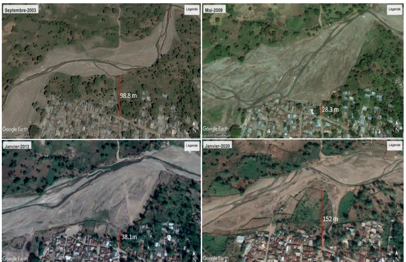
Figure 1. Evolution des constructions par rapport au comportement de la Rivière Mancelle sur une section en aval de la ville de Gros-Morne
