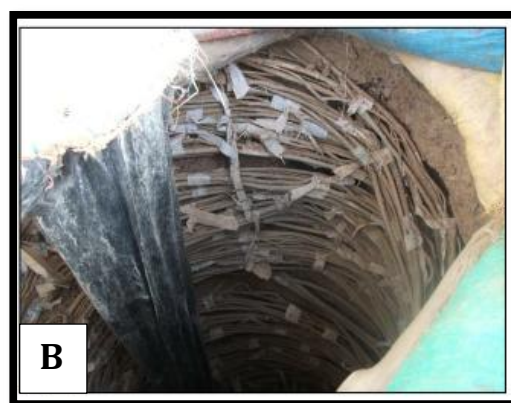
Photo 8 : A- Préparation de bois pour les trous d'orpaillage ; B- Soutènement des parois du trou d'orpaillage. (Photos Djibrilla 2017)
