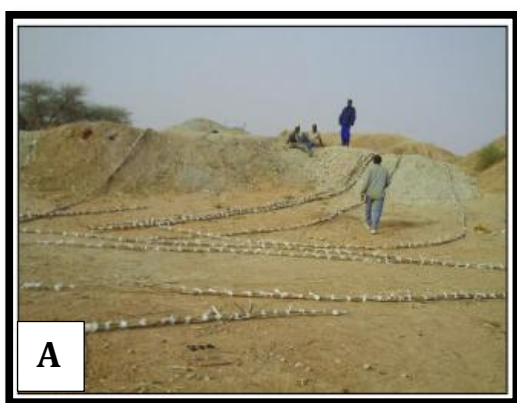
Photo 8 : A- Préparation de bois pour les trous d'orpaillage ; B- Soutènement des parois du trou d'orpaillage. (Photos Djibrilla 2017)
