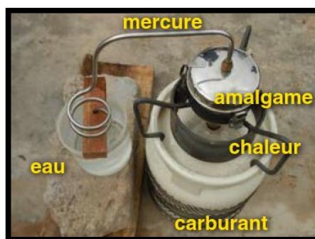
Photo 11 : Cornue Fauzi, (fabrication locale, Indonésie). (Photo Artisanal Gold Council 2014)
