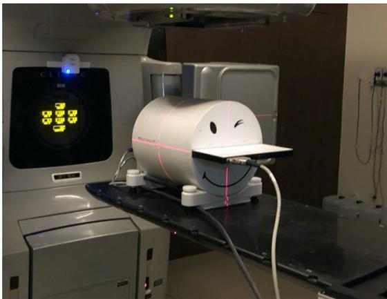
Figure 68 - Photographie de l'OCTAVIUS 4D avec le détecteur 1500 inséré dans la fente du fantôme prévue à cet effet.
