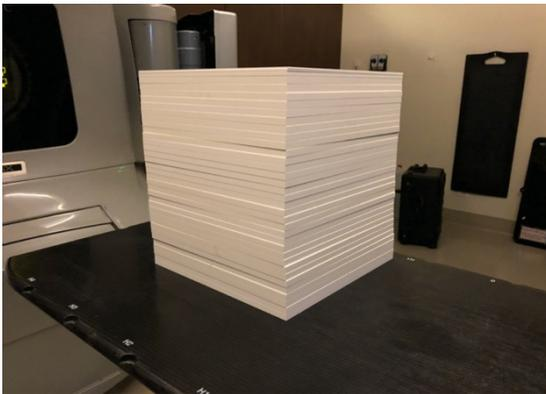
Figure 51 - Exemple d'un dispositif final pour un film radiochromique EBT3 situé à une profondeur de 298 mm et sur 40 mm de PMMA.
