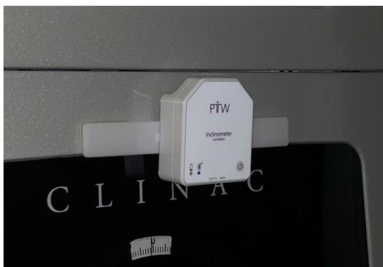
Figure 69 - Photographie de l'inclinomètre fixé à l'accélérateur linéaire.
