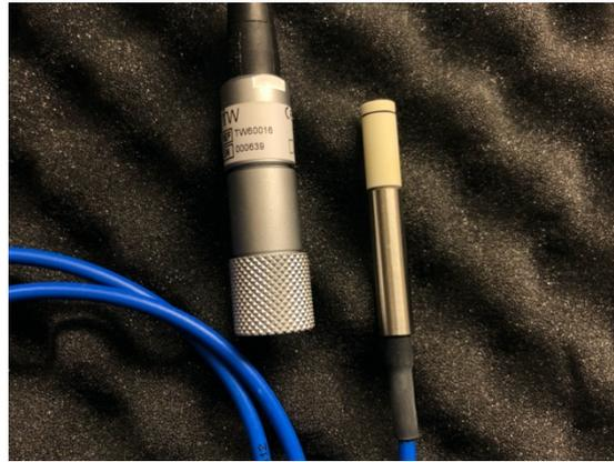
Figure 33 - Photographie de la diode blindée PTW 60017.
