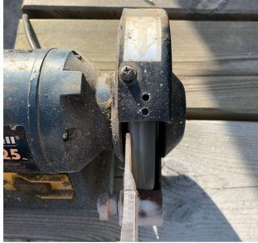
Figure 77 - Utilisation d'un touret à meuler pour la construction des demi tumeurs cylindriques.
