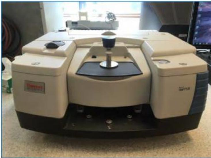
**Figure 18:** Photos d'un appareil à spectroscopie FTIR (source : APPEL, 2019)
