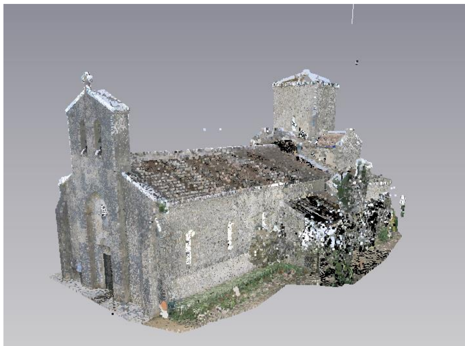
Fig. 62. Germigny-des-Prés. Nuage de points avec écart de 1cm de l'édifice retravaillé. 2016. Liège. (Retravaillé par HALLOT. P.) (source : LAMBRIGTS, R., 2019)
