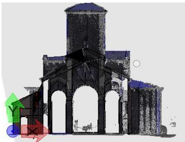
Fig. 91. Germigny-des-Prés. Coupe mettant en avant l'arc triple séparant le sanctuaire et la nef de l'oratoire. Vue intérieure depuis l'ouest. 2019. (Microstation 3D) (LAMBRIGTS, R., 2019)
