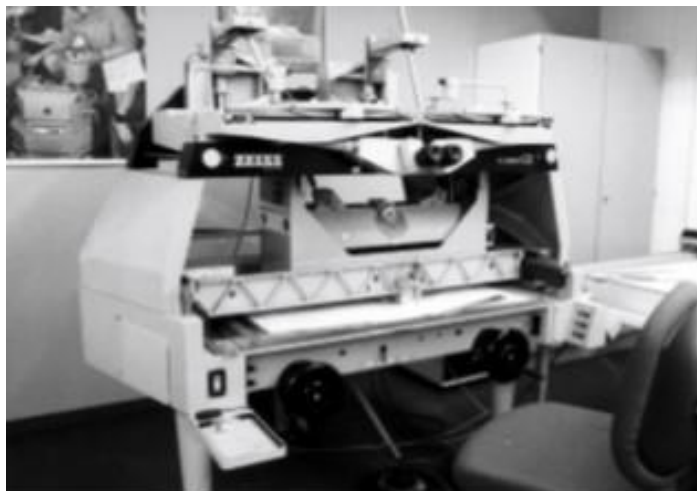
Fig. 49. Exemple de poste de traitement photogrammétrique analogique Planimat, Zeiss). S.l.n.d. (HÉNO, R. et CHANDELLIER, L., 2014, p. 34.)
