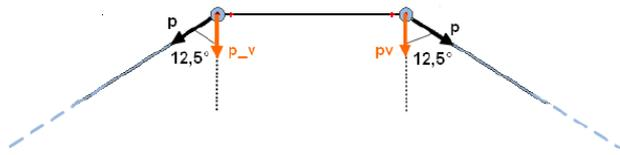
FIGURE 2.4 – Projection de l'effort p sur la passerelle (Source : Julie Lettner, Étude du confort vibratoire du "Geierlay", le plus long pont de singe d'Allemagne, 2017, p.39)
