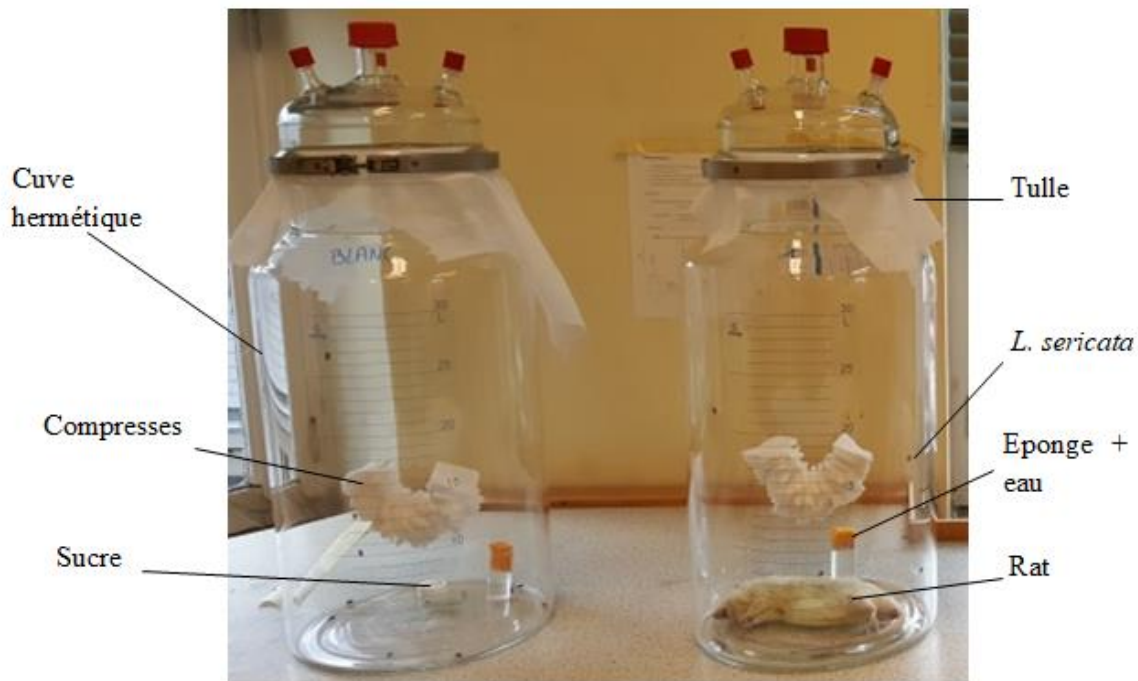
Figure 4. Dispositif expérimental utilisé pour collecter les COVs cadavériques émis par les rats lors de leurs différents stades de décomposition.
