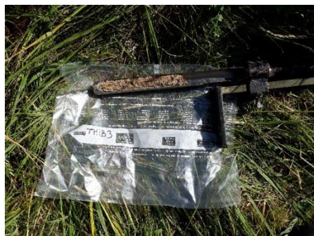
Figure 13 : Prélèvement de sol avec une tarière hémicylindrique pour échantillon composite.
