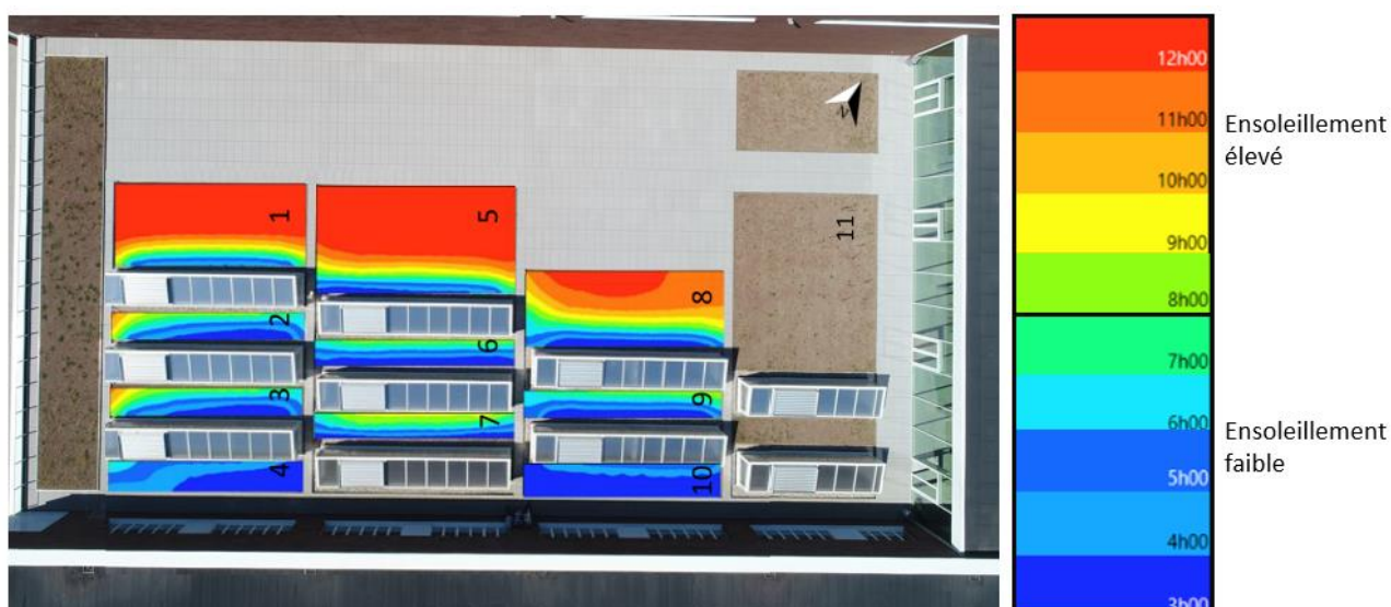
Figure 12- Illustration de la toiture expérimentale du TERRA et de l'ensoleillement des parcelles (Bernard et al., 2018). Les parcelles étudiées sont les 4, 5, 6, 7, 8, 9, 10 et 11.
