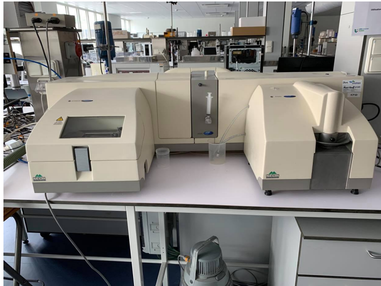
Figure 22 : Granulomètre laser MALVERN Mastersizer 2000© (Gembloux Agro-Bio Tech, 2020)
