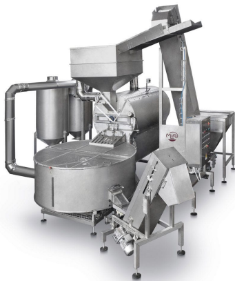
Figure 3 : Torréfacteur industriel pour oléagineux (Oil-press-machine, 2019)
