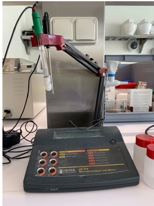
Figure 18 : Microprocessor pH mètre Hanna instruments© (Gembloux Agro-Bio Tech, 2020)
