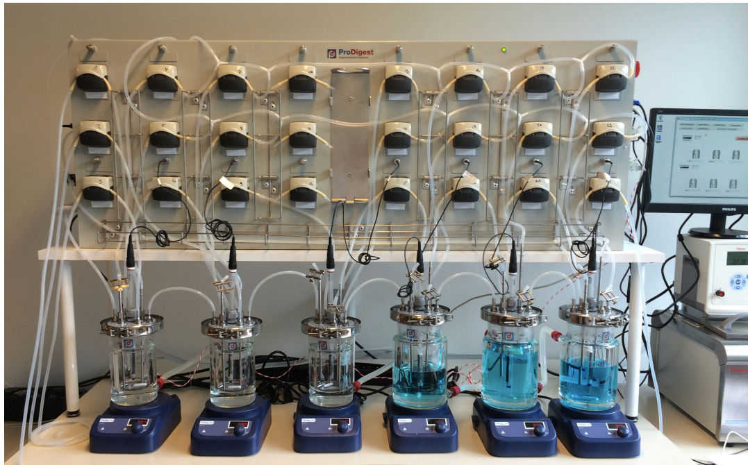
Figure 31 : Représentation schématique du modèle SHIME© (Van den Abbeele et al , 2010)
