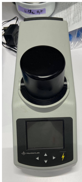
Figure 14 : Colorimètre spectrophotomètre HunterLab type ColorFlex EZ® (Gembloux Agro-Bio Tech, 2020)
