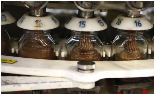
Figure 6 : Injection de pâte à tartiner dans les pots (Echo, 2018)
