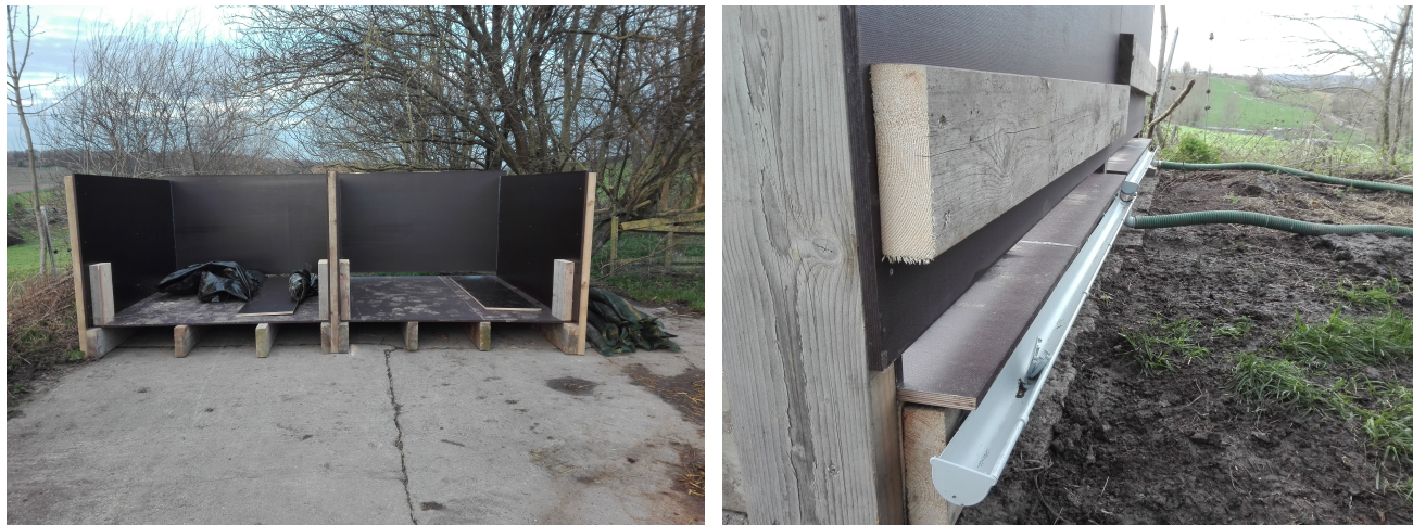
FIGURE 8 – Dispositif expérimental pour les essais en tas : coffrage (à gauche) et gouttières pour la récupération des écoulements (à droite).
