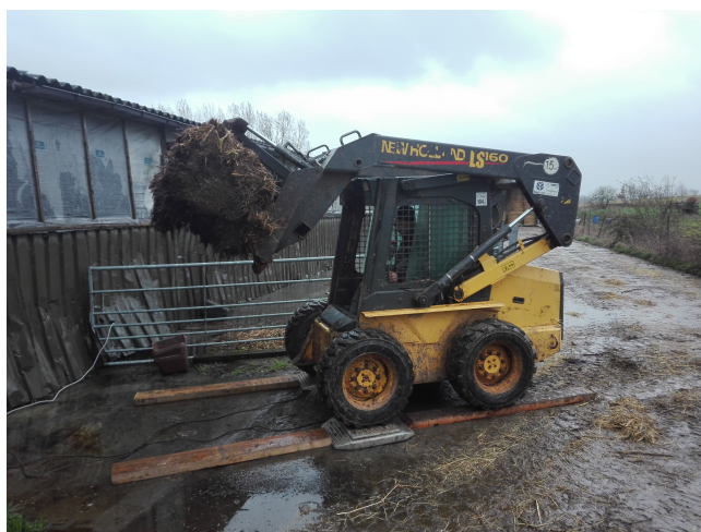
FIGURE 11 – État des tas avant pesée au jour 47 (à gauche). Mesure du poids des tas à l'aide d'un chargeur compact et d'un pont-balance à deux plots (à droite).
