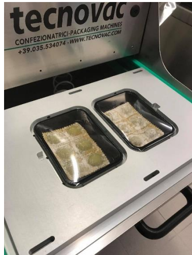
Figure 88 : Conditionnement en barquette thermoformée dans une machine tecnovac.
