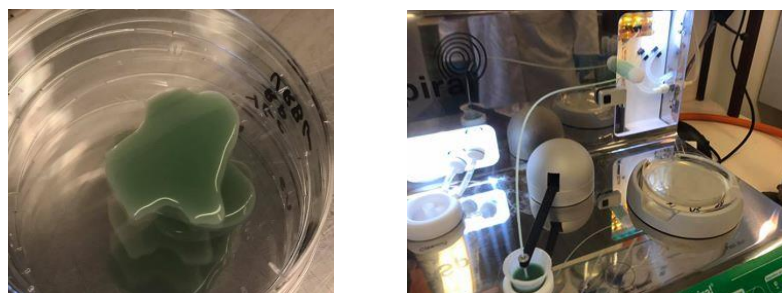
Figure 96 : De la gauche vers la droite : Ensemencement en profondeur sur boîte de Pétri vide, Ensemenceur en spirale.
