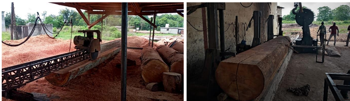
Figure 20. Scie mobile (gauche) et scie de tête (droite). Source: Brieuc Plas (2020).
