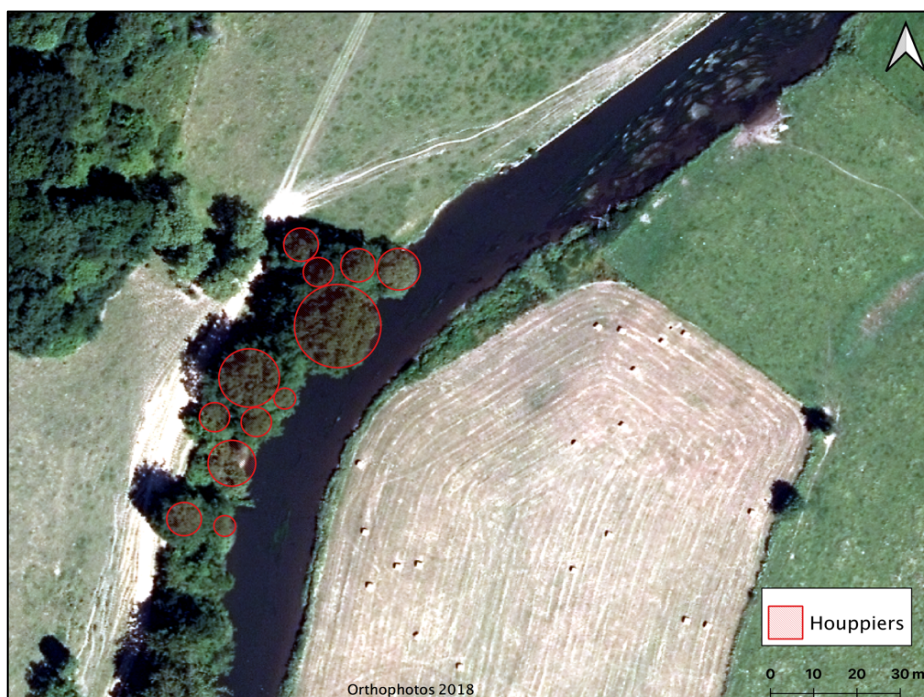
Figure 4 : Exemple illustrant les houppiers d'arbres inventoriés sur le terrain dont la couronne a été matérialisée par un disque dans un SIG.
