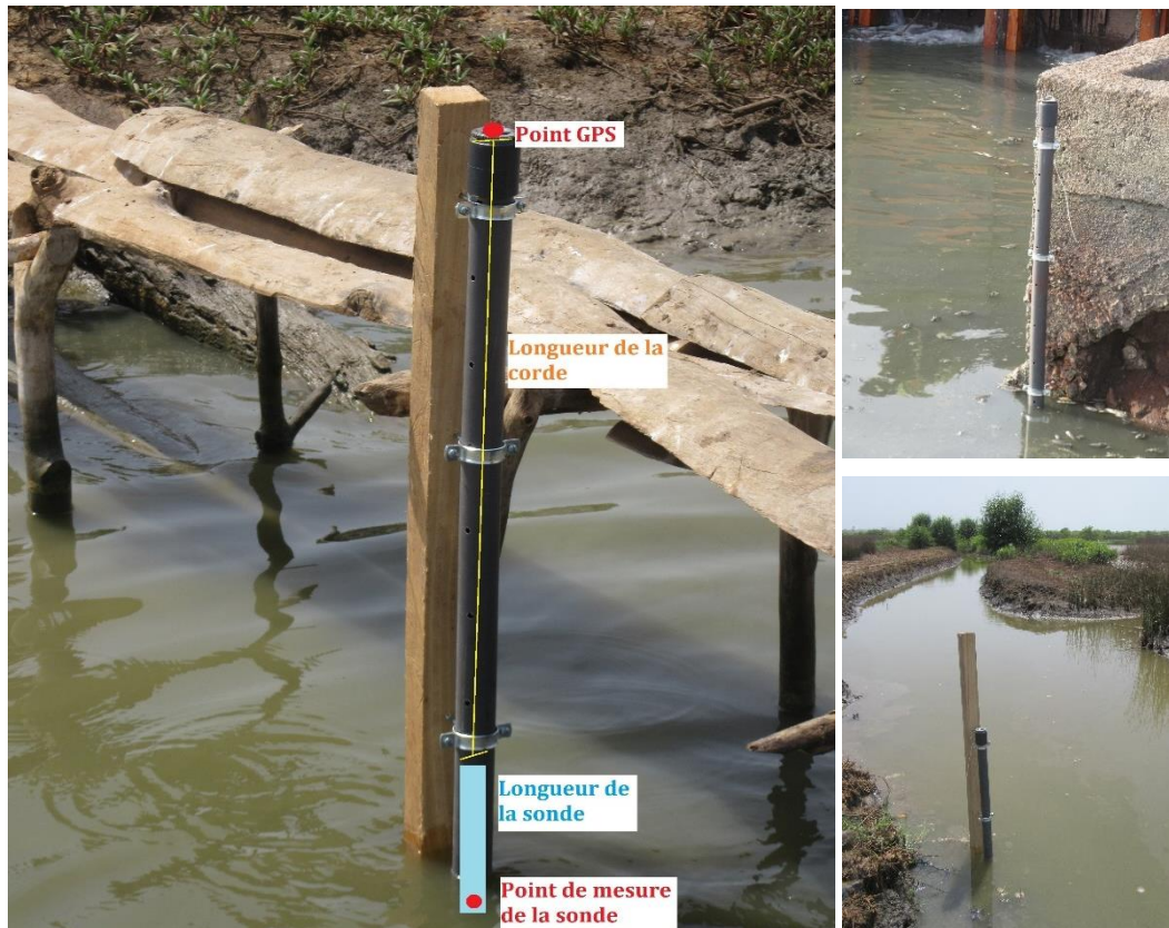
Figure 11 – Installation des sondes au sein de la plaine (droite) et système de mesure (gauche)
