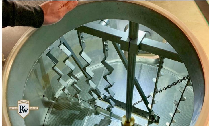
Figure 4 : Cuve de filtration avec son système de grille perforée et ses râteaux tournants (Lauter tuns and brewing equipment, s.d.).
