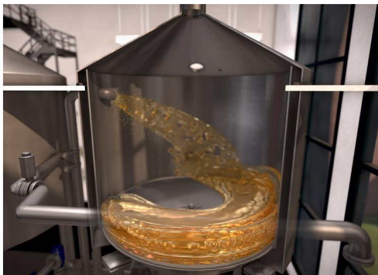
Figure 5 : Illustration du principe de fonctionnement d'un whirlpool (3D animation The art of brewing, s.d.).
