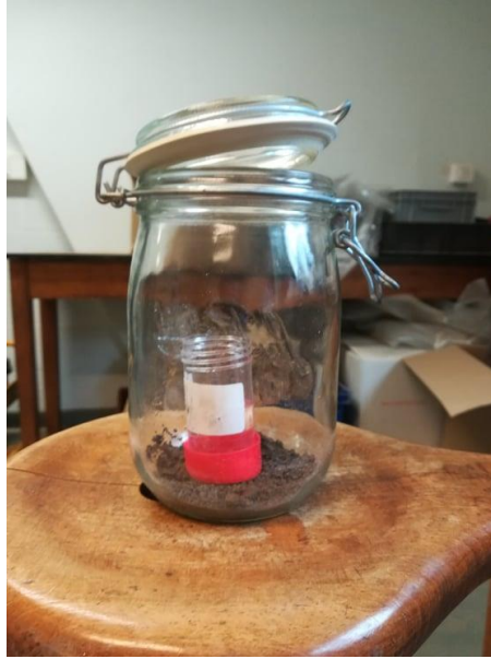
Figure 12 : Bocal contenant l'échantillon de terre sèche et le pilulier contenant la solution de NaOH pour le test de respirométrie
