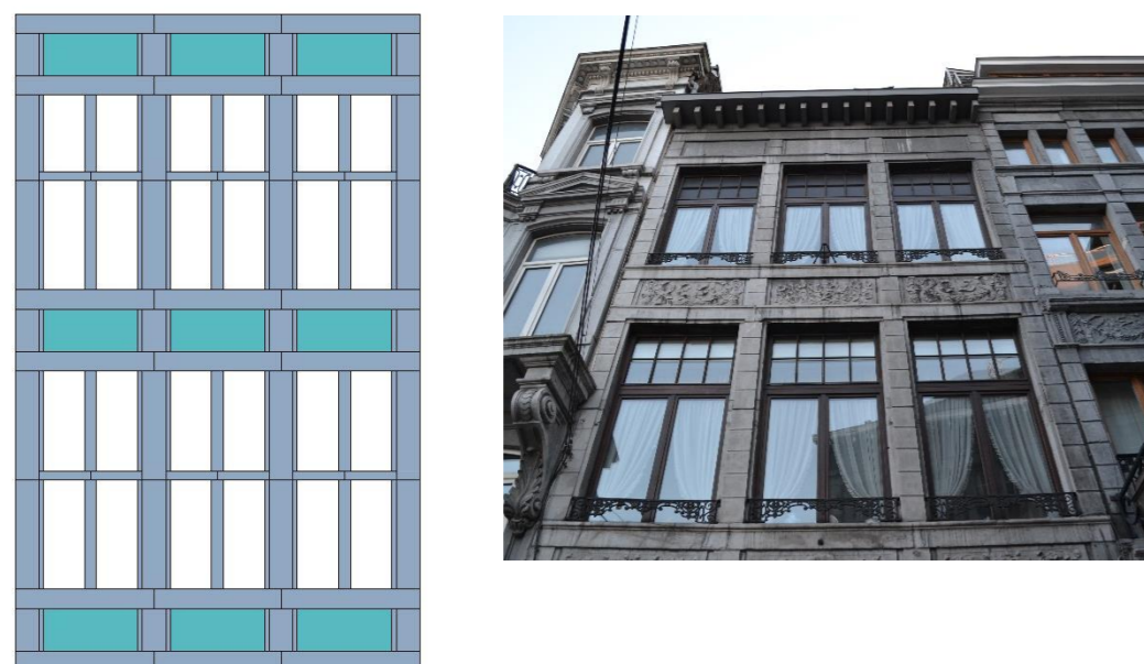
95. Schéma structurel et photo de la façade en Neuvise 58 à Liège 95 .
