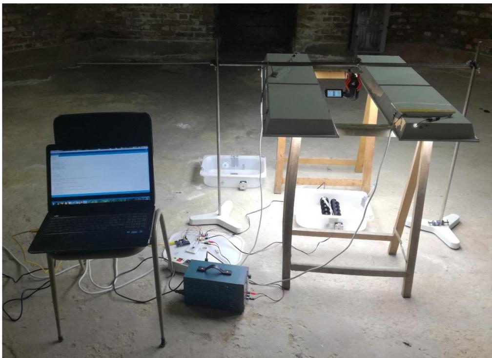
*Figure 19 Dispositif de brassage et suivi vidéo, (Source : Florent Lowet).*
