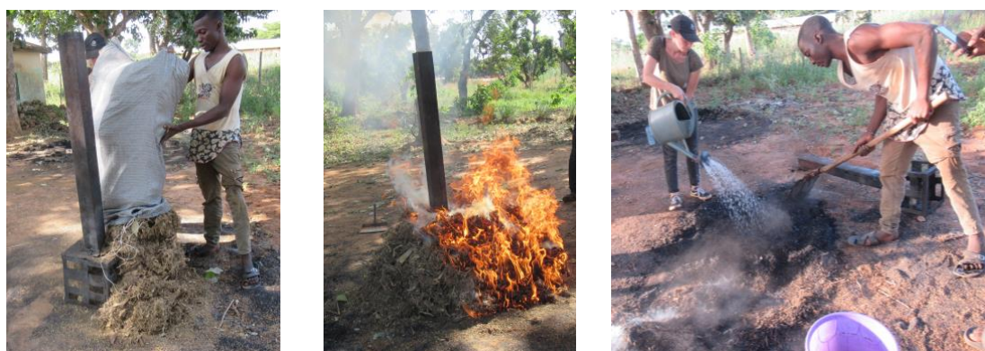
Figure 14: Système artisanal de pyrolyse (gauche), accélération de la combustion (centre) et refroidissement du "char" (droite) (Marignol, 2020)
