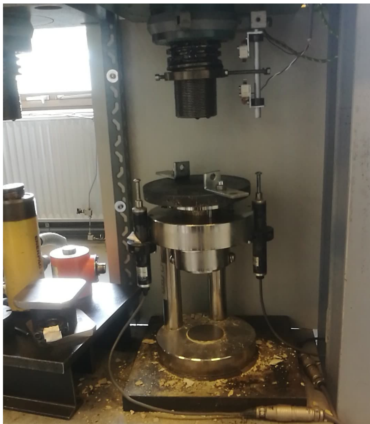
FIGURE 49 – Machine de compression simple pour matériaux rocheux
