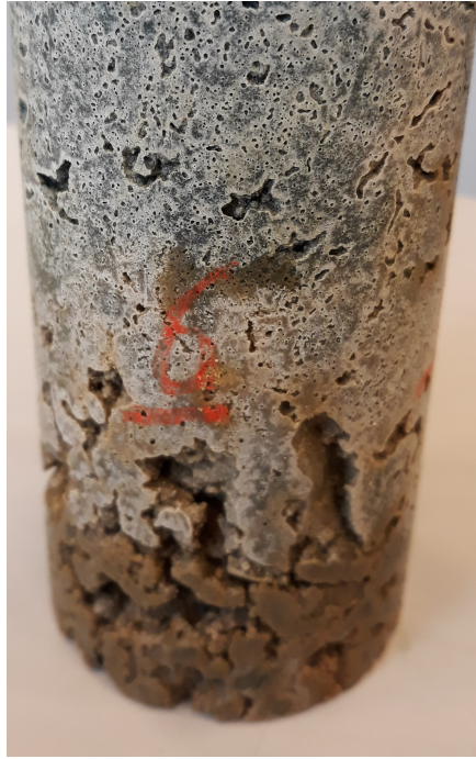
FIGURE 47 – Zone de fragilisation plus poreuse et moins résistante en partie inférieure
