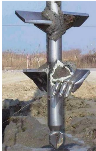
FIGURE 40 – Tête pour colonne de soil mix par voie humide [Denies, N. 2013]
