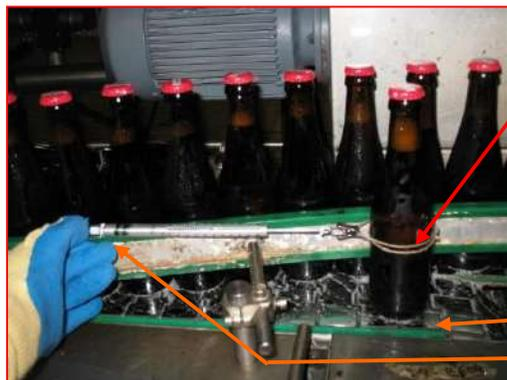
**Attacher la bouteille au dynamomètre à l'aide d'un élastique ou d'une fine corde en faisant 2 tours autour de la bouteille**
