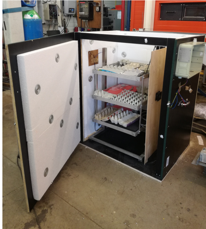
FIGURE 4 – Photo du caisson réalisé - Le mécanisme de basculement des œufs est aisément introduit. Les capteurs sont placés sur la gauche de la couveuse, tandis que le dispositif électronique est disposé à l'extérieur. Un trou percé dans la paroi permet de faire passer des câbles tirés entre la carte électronique, l'alimentation extérieure et les composants à l'intérieur (capteurs, ventilateurs, lampes, moteur).
