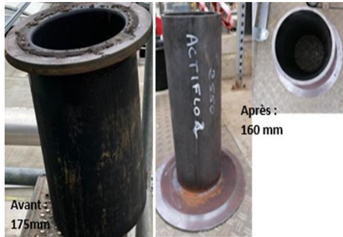
Figure 27: Modification diamètre buse surverse de 175 à 160 mm
