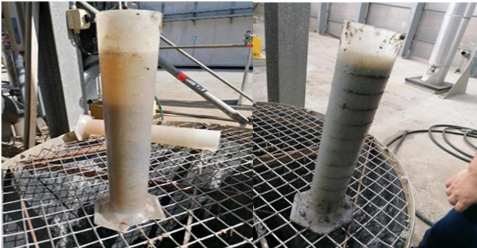
Figure 17: Echantillon TS sousverse pour lecture quantité sable Actiflo ®
