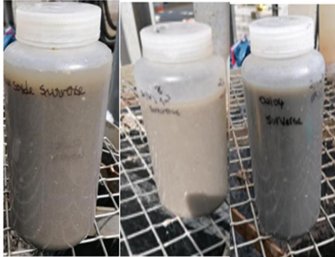
Figure 18: Différentes textures des boues de la surverse des hydrocyclones Répéter le même mode opératoire pour les deux autres débits 1.8 et 2.6 m 3 /s
