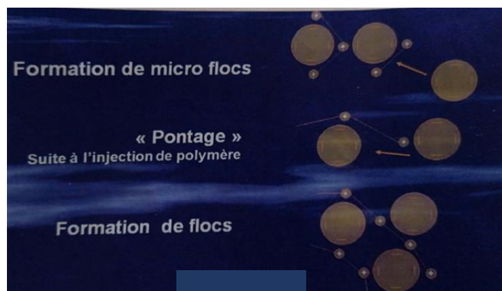
Figure 8: Rôle du polymère dans la floculation (Aquiris, 2008)
