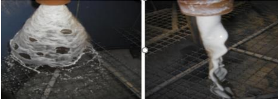
Figure 25 : exemple d'une décharge en parapluie (à gauche) et en boudin (à droite) (Davailles, 2011)
