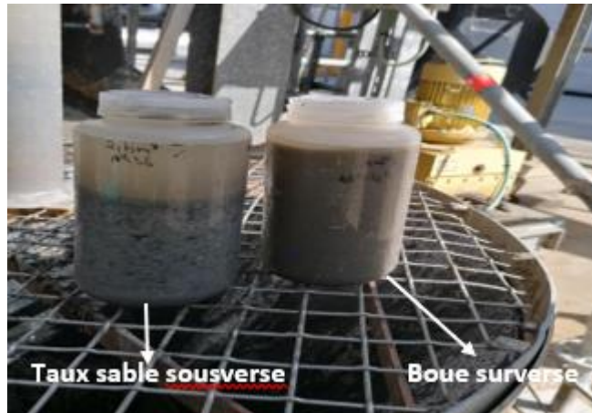
Figure 30: Echantillon de sable et de boue prélevé sur l'hydrocyclone 2550
