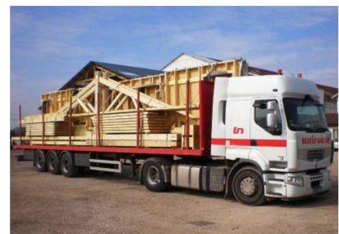
Figure 29 : Transport d'éléments préfabriqué [Esp19].
