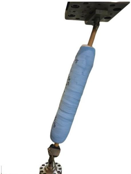
**Figure 4** : Schéma modélisant la structure entourée du BRJ dans la presse Zwick-Instron (200 daN load cell) lors du protocole de charge quasi-statique en compression/flexion. (Voir texte)
