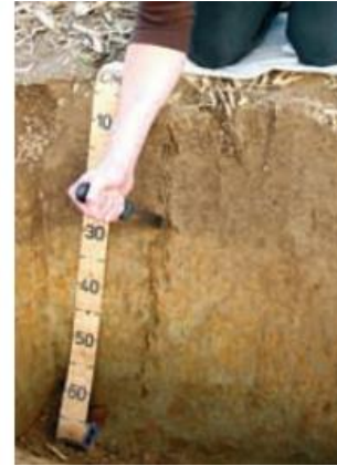
Figure II.7.3.4. Références pour la profondeur potentielle du développement des racines (a), et méthode d'évaluation de la profondeur de semelle de labour (b). Source : Sheperd et al., 2018
