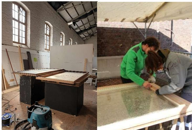
17. Préparation et ponçage des châssis bois.
