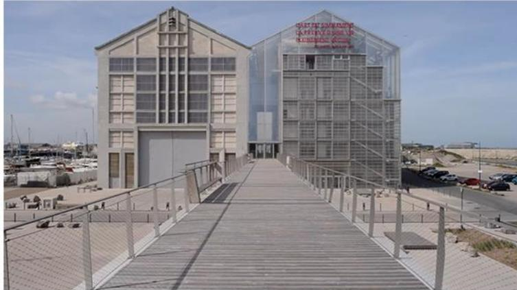
Fig. 48 Façade comprenant les deux systèmes décrits ci-avant. Polycarbonate en partie inférieure et coussins ETFE en partie supérieure.
