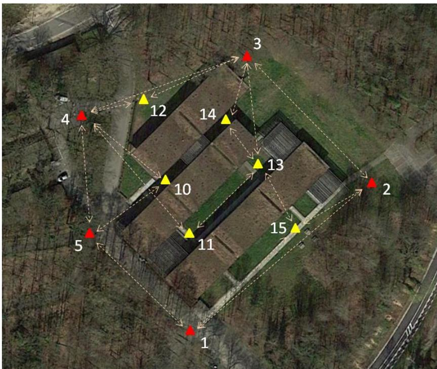
Figure 27 : Schéma de la polygonale reprenant les positions des stations et les inter-visées
