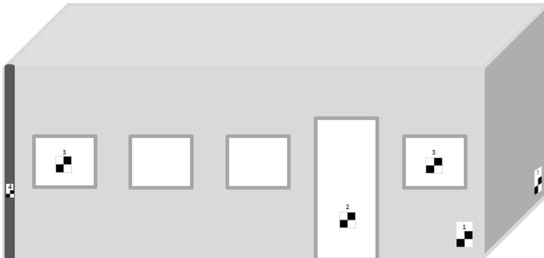
*Figure 6 : Positionnement des cibles pour la méthode des cibles*
