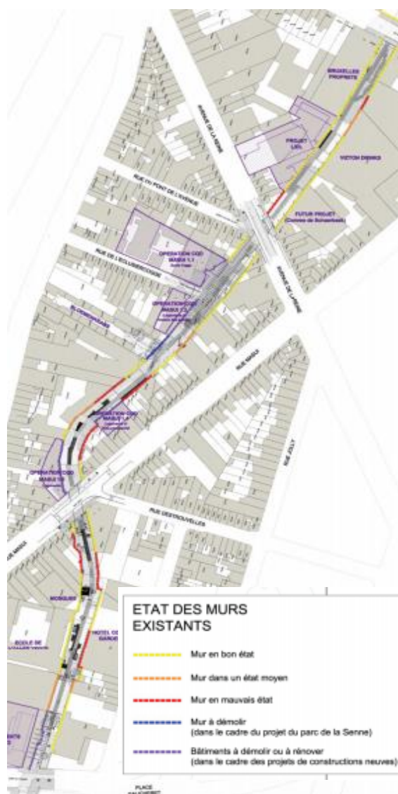
Figure 184: Etat des murs existants du parc de la Senne. Source: Demande du PU du Parc de la Senne. Plan transmis par Bruxelles Environnement.
