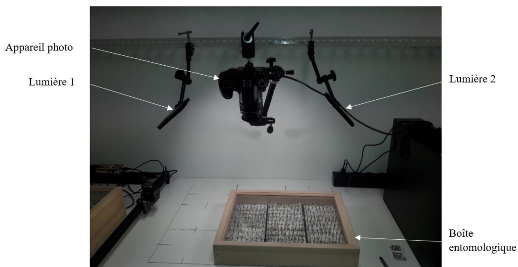
Figure 8 : Photographie de l'installation de l'appareil photo pour la prise en photo des boîtes entomologique.
