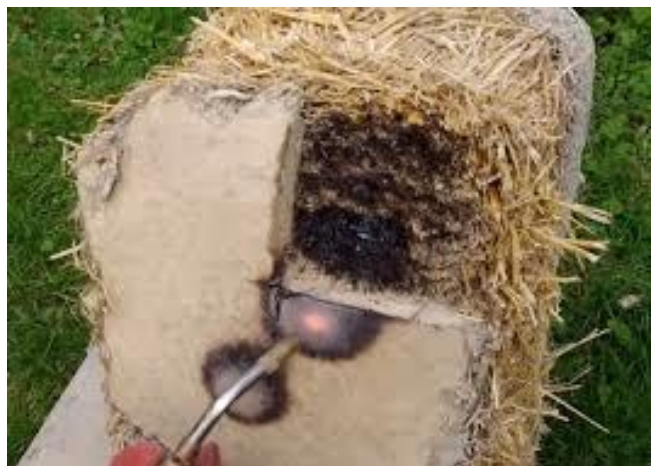
Figure 15 – Résistance au feu d'un ballot enduit
