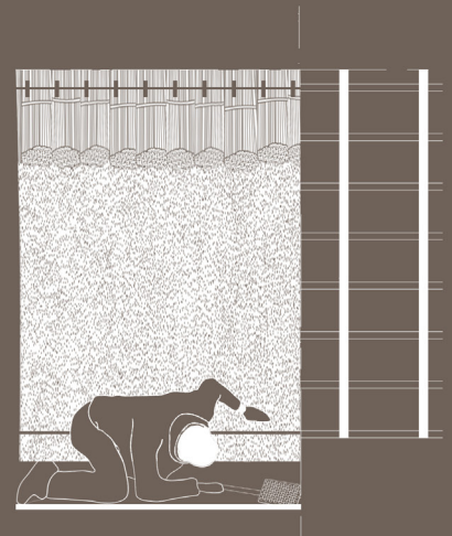
b. Retouche du larmier pendant la pose de la couverture
