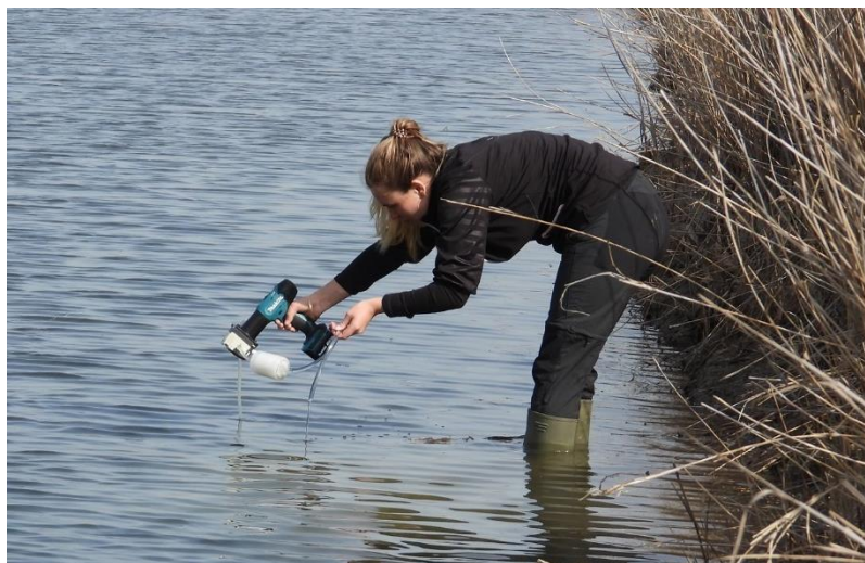
Figure 6: Prélèvement d'eau à l'aide d'une pompe péristaltique de la marque Brükle
