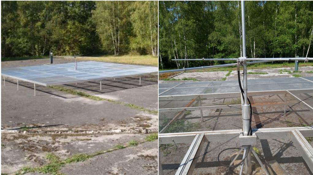
FIGURE 4.2: L'émetteur de Dourbes est composé d'une antenne dipolaire croisée et d'une grille réfléchrice.
