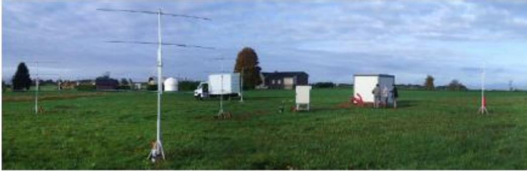
FIGURE 4.6: L'interféromètre situé à Humain, composé de 5 antennes Yagi en configuration Jones
