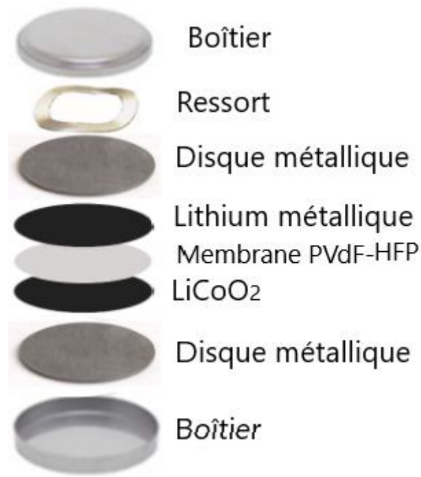
Figure 8 : Les composants d'une pile bouton expérimentale.
