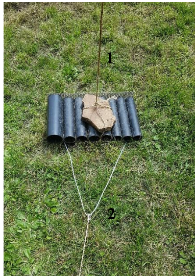
Figure 6.19 : Proposition d'amélioration pour les refuges artificiels avec une corde pour descendre le piège (1) et une corde pour remonter le piège (2)
