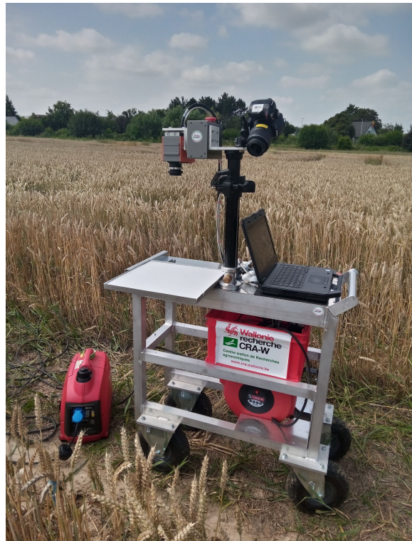
Figure 9 – Le chariot équipé d'un capteur hyperspectral et de l'appareil photo numérique
