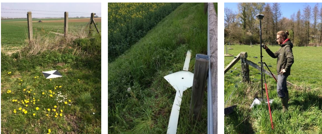
Figure 8 : Disposition des cibles et géoréférencement (Photo : Herman V.)
