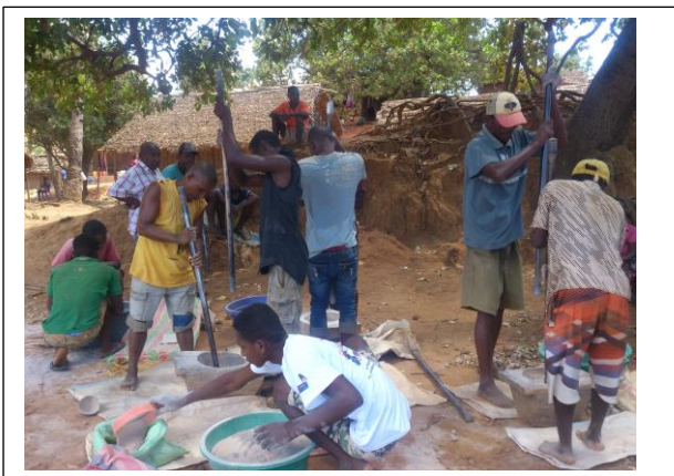
Figure 10 Broyage et tamisage des minerais (Agence National de la filière Or (ANOR), 2016)
