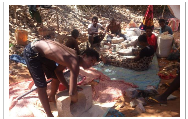
Figure 10 Broyage et tamisage des minerais (Agence National de la filière Or (ANOR), 2016)
