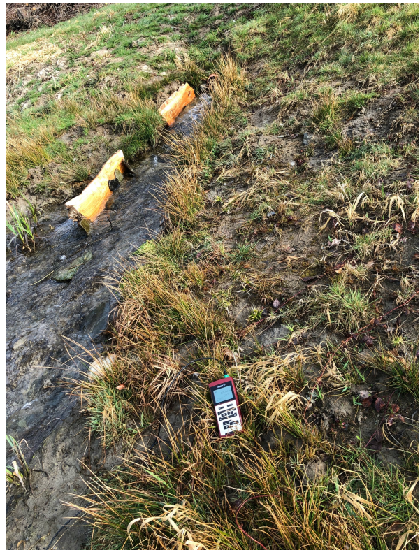
Figure 9 : Conductimètre placé au milieu de l'écoulement.
