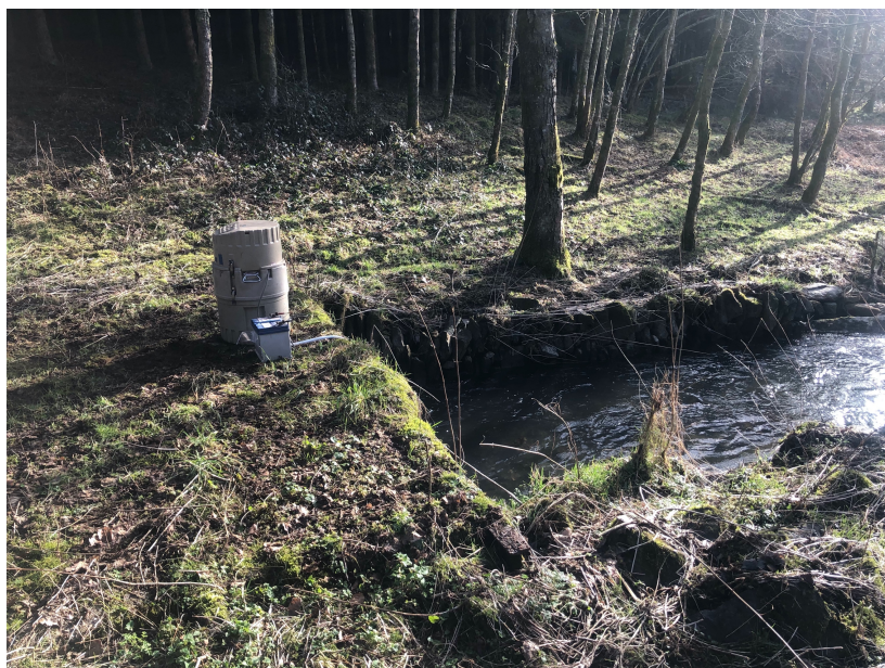
Figure 7 : Échantillonneur placé dans le ruisseau au niveau de la prise d'eau.
