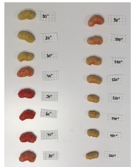
Figure additionnelle 15. Évolution de la couleur des snacks au cours de l'avancement du colorant Rouge Allura au sein du fourreau pour une vitesse de vis de 200 rpm.
