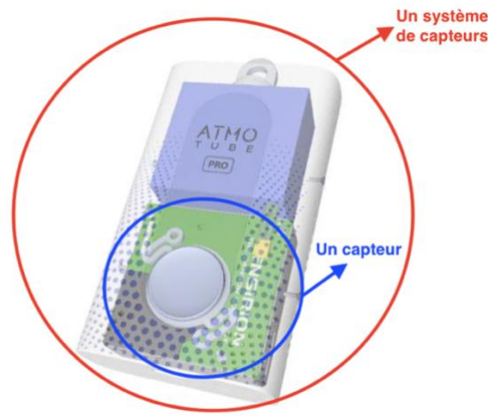
Figure 3. Schéma représentant l'intérieur d'un Atmotube , illustrant les notions de capteurs et système de capteurs. Source : notAnotherOne/Atmotube, (n.d.)
