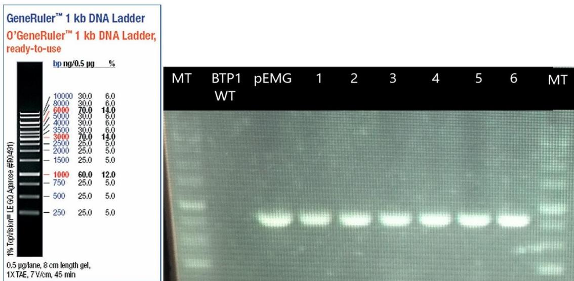
Figure n°23 – Migration sur gel d'agarose 1% des amplifications par PCR sur colonies de la cassette de résistance à la kanamycine. Les amplicons ont une taille de 800 paires de base. Les amorces utilisées sont : nptIIF/nptIIR. Les chiffres 1 à 6 correspondent aux colonies obtenues après conjugaison. MT = marqueur de taille.
