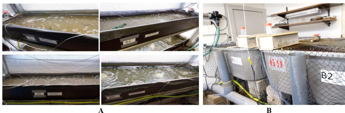
Figure 3 : Bacs rectangulaires de 250 l contenant du biofloc (A) et bacs sub-carrés de 300 l (B).
