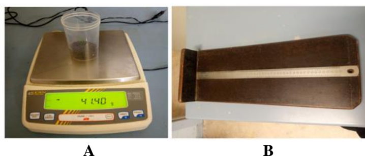
Figure 5 : Balance électronique (A) ( \pm 0,1g ) et ichthyomètre (B).
