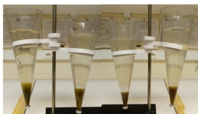
Figure 8 : Flocs décantés dans des cônes d'Imhoff.
