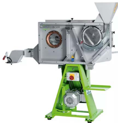
Figure 17 : Décortiqueuse de laboratoire utilisée lors du décortiquage des graines de tournesol, (AG, Wintersteiger, 2021)
