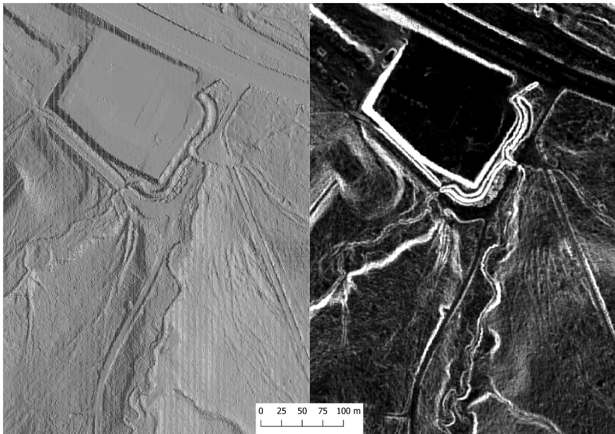
Figure 15. Comparaison entre une couche hillshade classique (gauche) et une couche hillshade retravaillée avec la fonction "rugosité" (droite). Zoom sur une zone de la commune de Nassogne
