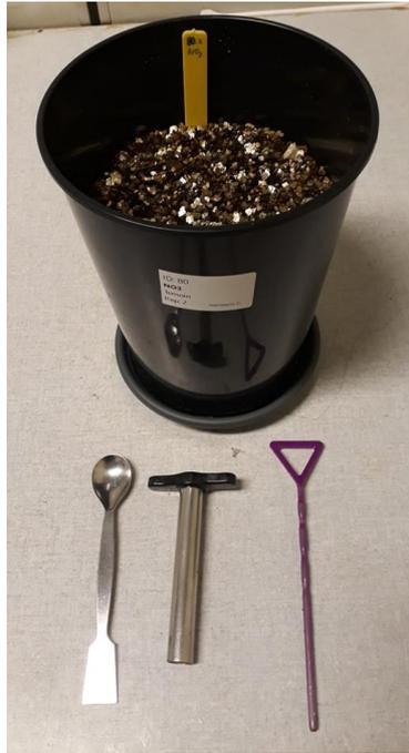
Figure 13. Prélèvement de la vermiculite pour le dosage d'azote. Utilisation d'une cuillère et d'un tube métallique.
